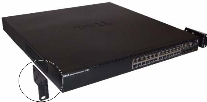
Figura 1-11. Fixação dos suportes
