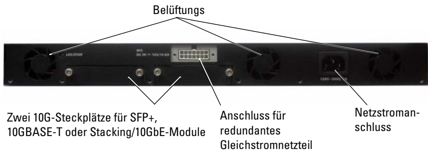
Abbildung 1-8. Rückseite von PC7024, PC7024F und PC7048
